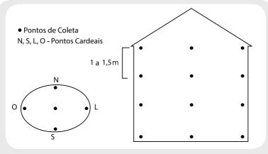
Figura 12 – Coleta de amostra em silo vertical.
