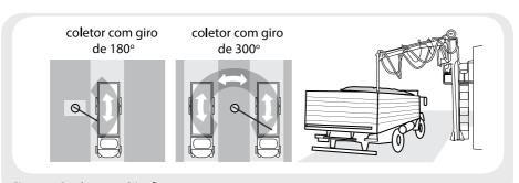
Figura 4 - Sonda pneumática fixa
