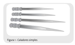
São extratores, geralmente metálicos, utilizados para a retirada de amostras em sacaria de aniagem, polipropileno ou algodão através de simples furação dos sacos contendo produtos como arroz, café, feijão, milho, soja, trigo, sorgo e outros tipos de grãos.
