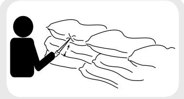
Figura 14 – Coleta de amostra com calador simples
