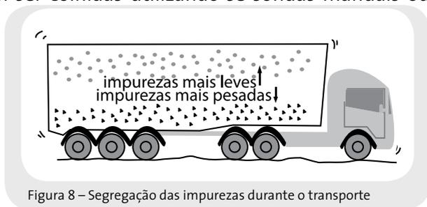
Figura 8 – Segregação das impurezas durante o transporte
